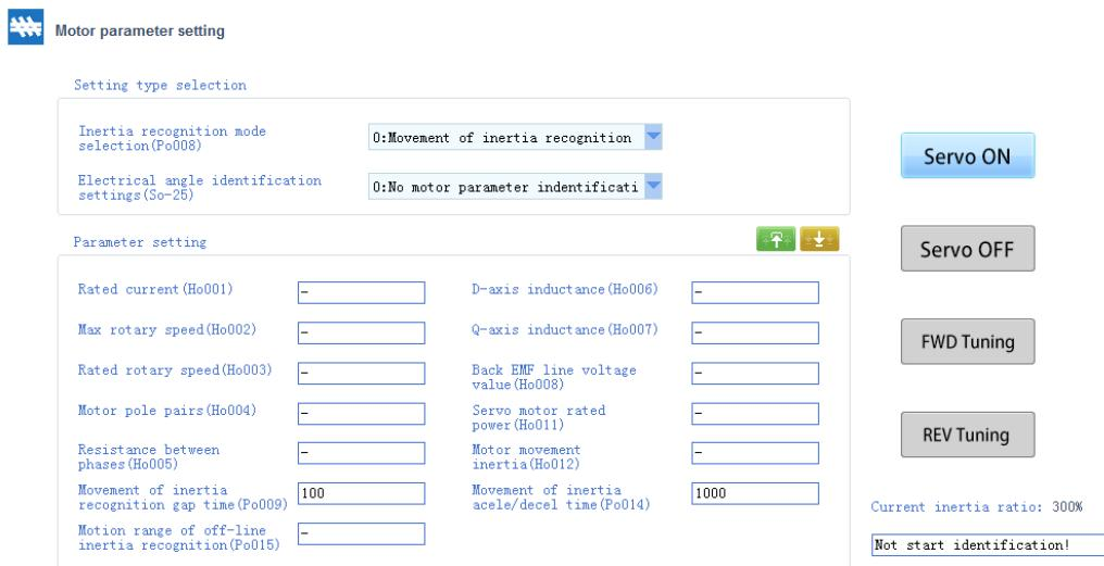
**Fig 3-2-37 Motor parameter setting interface**
